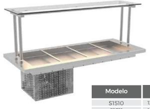
Construído em aço inoxidável. Sistema de refrigeração automático por serpentinas com controle de temperatura. Unidade de refrigeração incorporada; Cabine lado direito. Botão liga/desliga com iluminação. Temperatura de trabalho: +2°C a +6°C. Protetor salivar com iluminação em led, Potência: 1/4 HP Tensão 220 V. monofásico.
