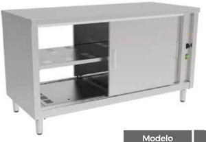
Corpo interno e externo em aço inoxidável. Isolamento térmico em lã de rocha. Sistema de aquecimento por meio de resistência elétrica com ar forçado na lateral e gaveta umidificadora removivel. Termocontrolador digital de temperatura. Temperatura de trabalho: até 85°C. Portas de correr. Acompanha 01 par de cantoneira ajustavel para receber GN 1/1 Gastronorm e 01 grade com pintura epoxi por porta (gn's não inclusos). Não possui tampo superior. Potência: 1,5 Kw Tensão 220 V. monofásico.
