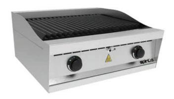
Construído em aço inoxidável com grelhas em ferro fundido; Defletor radiante em ferro fundido; Queimadores tubulares esmaltados; Sistema de segurança contra falta de chamas; Bandeja coletora de resíduos; Manípulos com ajuste gradual de chama; Painel frontal construído de forma a proteger os manípulos e facilitar a higienização; Sapatas niveladoras.
