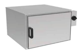
Construído em aço inoxidável; Aquecimento através de galeria especial de queimador tubular; Câmara interna de 605x695x350 mm; Controle de temperatura por termostato; Sistema de segurança contra falta de chama; Grade interna niquelada; Painel em aço inoxidável com graduação de temperatura e manípulo em baquelite.
