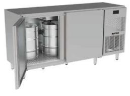
Frente e laterais externas em aço inox serie 400, interno em alumínio liso. Isolamento em poliuretano injetado de alta densidade. Sistema de refrigeração por meio de ar forçado. Gás ecologico R-134a. Termocontrolador digital de temperatura. Temperatura de trabalho: +2°C a +6°C. Unidade compressora selada incorporada com cabine do lado direito. Potência: 1/3+ HP Tensão 220 V. monofásico. Não possui tampo superior.
