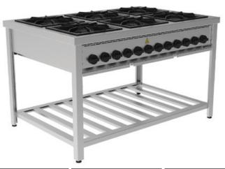
Tampo e estrutura em aço inoxidável; queimadores duplos tipo cachimbo e coroa; Grelhas 400x400mm em ferro fundido; Bandeja coletora de resíduos; Manípulos em baquelite com ajuste gradual de chama; Painel frontal com indicação de fogo alto e baixo; Construído de forma a proteger os manípulos e facilitar a higienização; Prateleira inferior gradeada; Pés com niveladores de altura.
